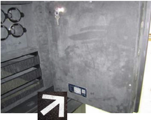
Батарейный отсек находится в нижней части сейфа.
